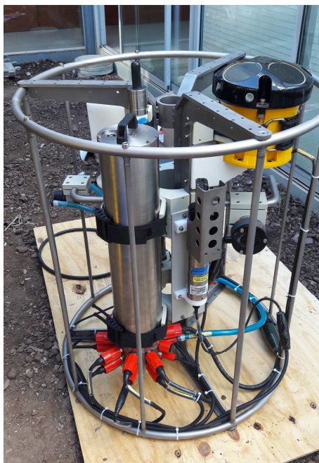
Un exemplaire de COSTOF2, au premier plan à gauche, monté sur un EMSO Generic Instrument Module : EGIM.
